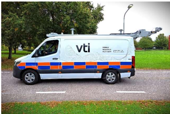
Bild 1: Mätbil för vägyte- och vägområdesmätning (Foto: VTI)
